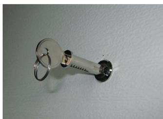
Côté intérieur, attacher la cordelette au barillet
